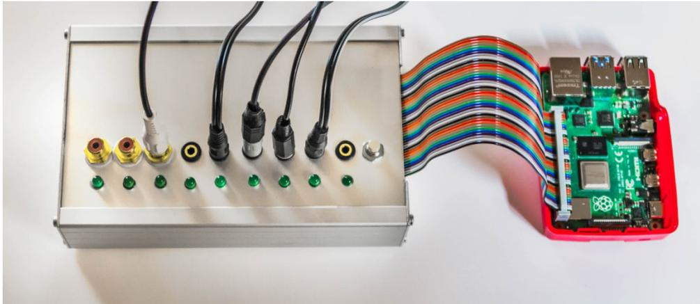
Abbildung 4: Raspberry Pi 4B+ und Anschlussbox
